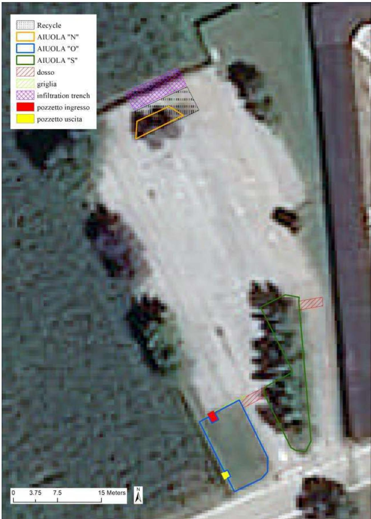
Figura 4.1: Ortofoto con indicazione delle tre aiuole, dei pozzetti e dei dossi che verranno inseriti da progetto.
