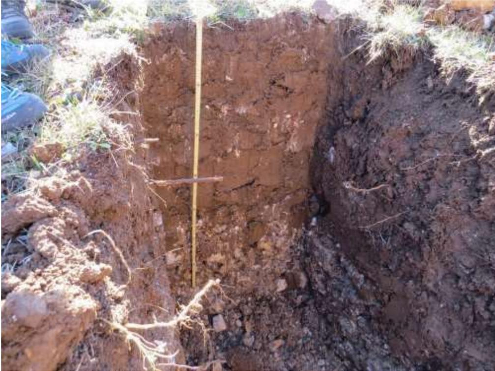
*Figura 7.12. Profilo pedologico dello scavo con riferimento metrico. Profondità di scavo 1,5 m.*
