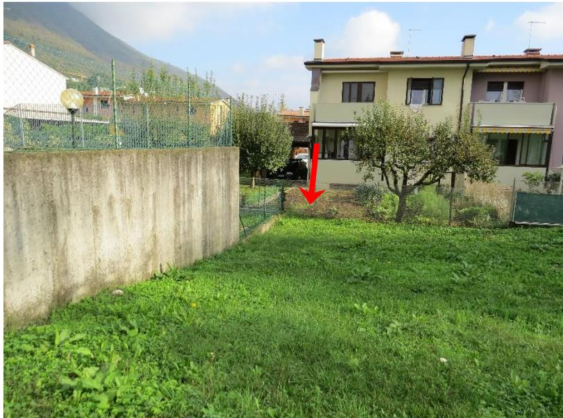
*Figura 2.3: Angolo delimitato da muretti, alla base del versante settentrionale della collina del Grumo: la freccia rossa indica il punto topograficamente più basso dove si accumula l'acqua di deflusso superficiale che defluisce dal versante nord della Collina del Grumo.*
