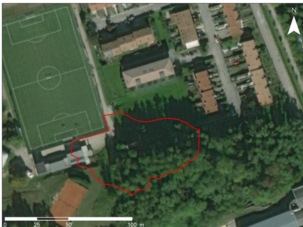
*Figura 4.2: Area drenata (in rosso) dal canale di gronda in progetto: i deflussi superficiali prodotti in questa porzione della collina verranno indirizzati verso un'area di bioritenzione sul lato est della collina, andando ad alleggerire il contributo idrologico alla zona più critica dove si verificano gli allagamenti documentati in Allegato 1.*
