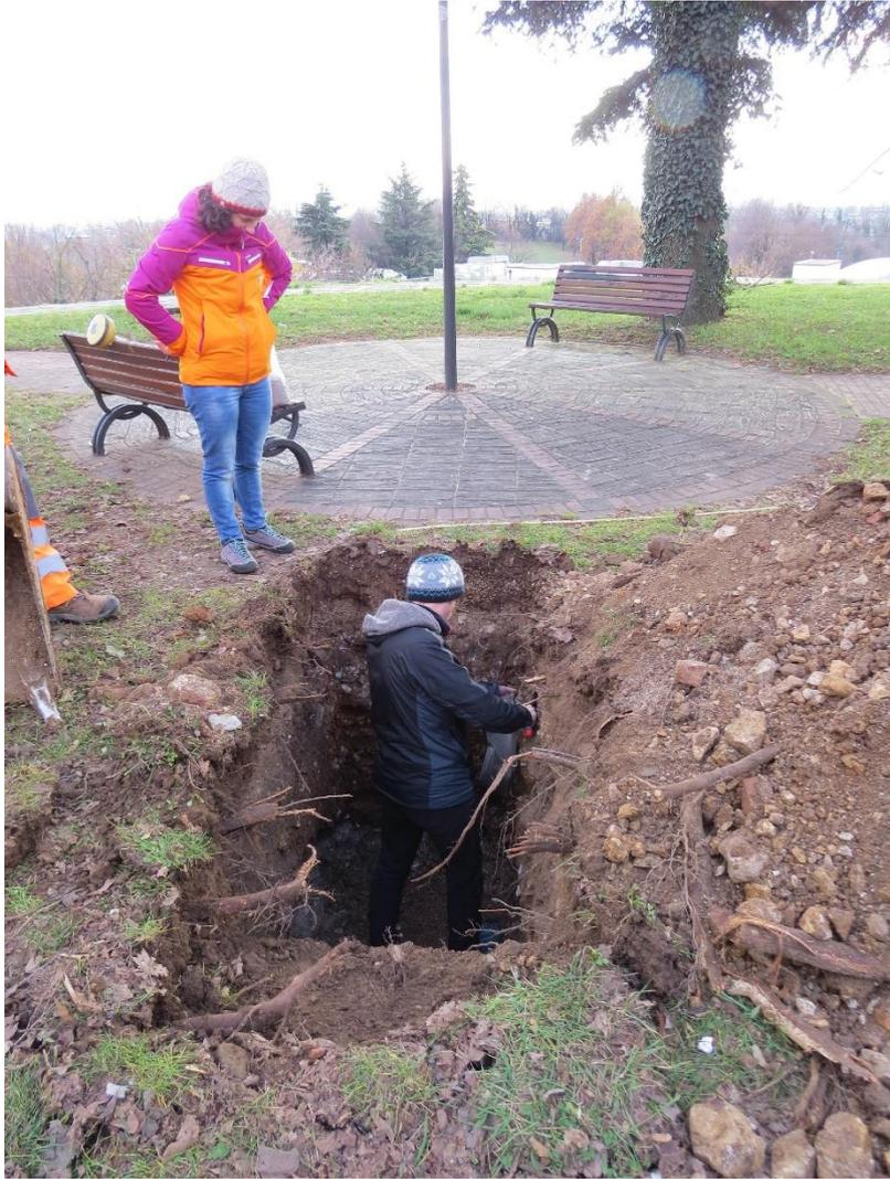
*Figura 8.10. Raccolta dei campioni di suolo a 1,50 m; 1 m; 0,5 m in sacchetti di plastica adeguatamente etichettati.*
