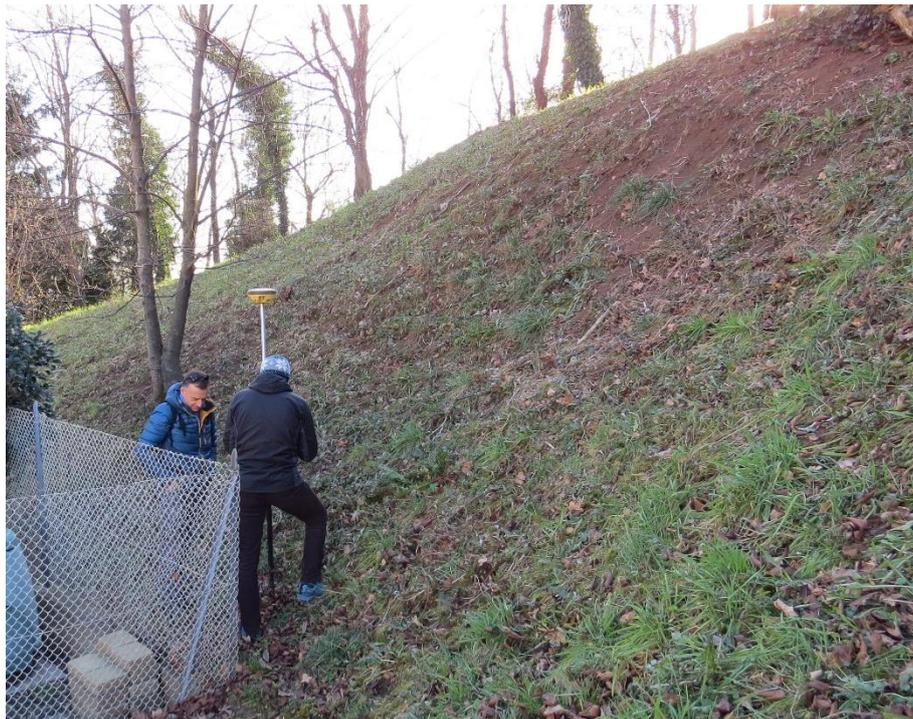
*Figura 4.4. Rilievi topografici nella zona in cui è prevista la realizzazione di una fascinata viva. Da notare in alto a sinistra le evidenze dell'attivazione di fenomeni di erosione superficiale causata dall'elevata pendenza del versante in questa zona.*
