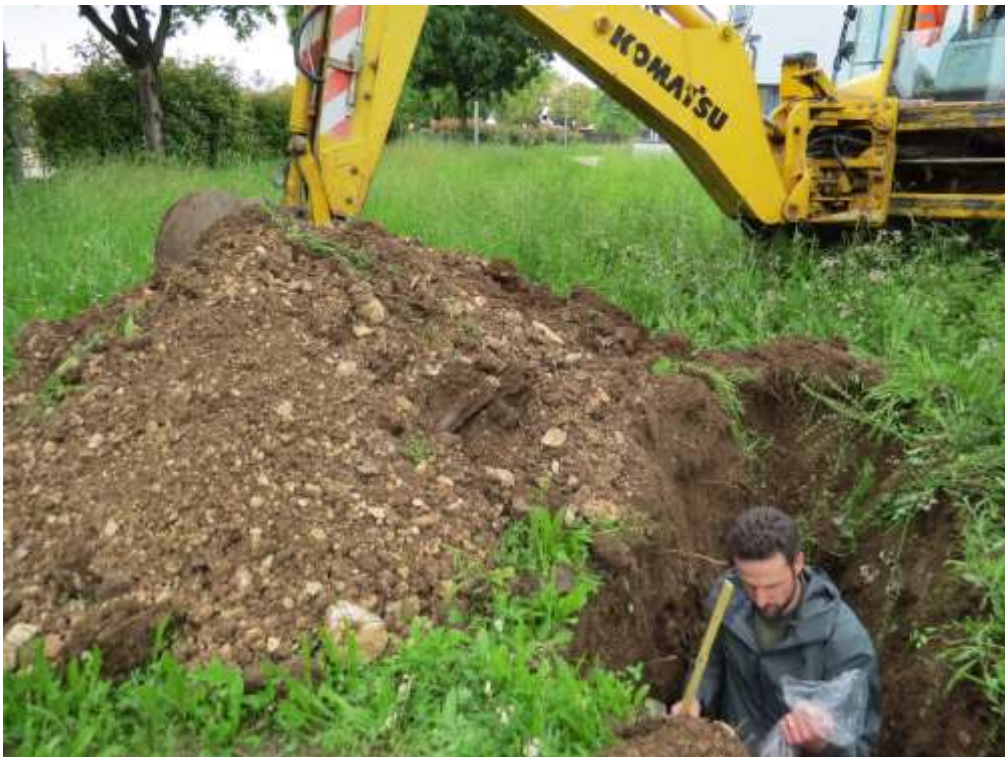
Figura 7.13. Scavo effettuato per l'identificazione del profilo pedologico nell'area del RG-SM.
