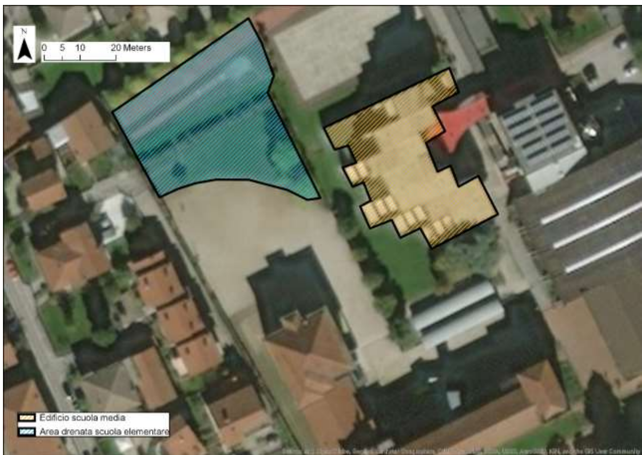
Figura 4.2: Le due superfici utilizzate per il dimensionamento delle opere verdi. L'area in azzurro genera i deflussi che saranno gestiti da RG-SE, pavimentazione Recycle e Tree-lined swale; l'area in arancio genera invece i deflussi che saranno gestiti dal RG-SM e dalla fioriera.
