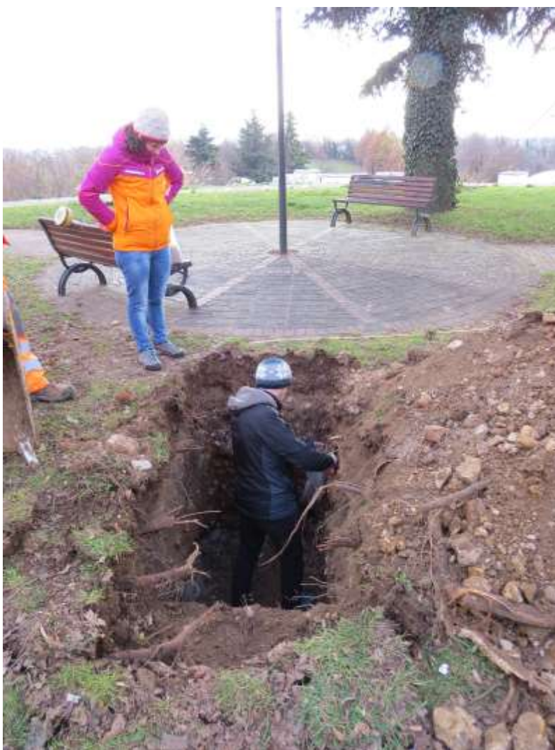
Figura 7.17. Raccolta dei campioni di suolo a 1,50 m; 1 m; 0,5 m in sacchetti di plastica adeguatamente etichettati.
