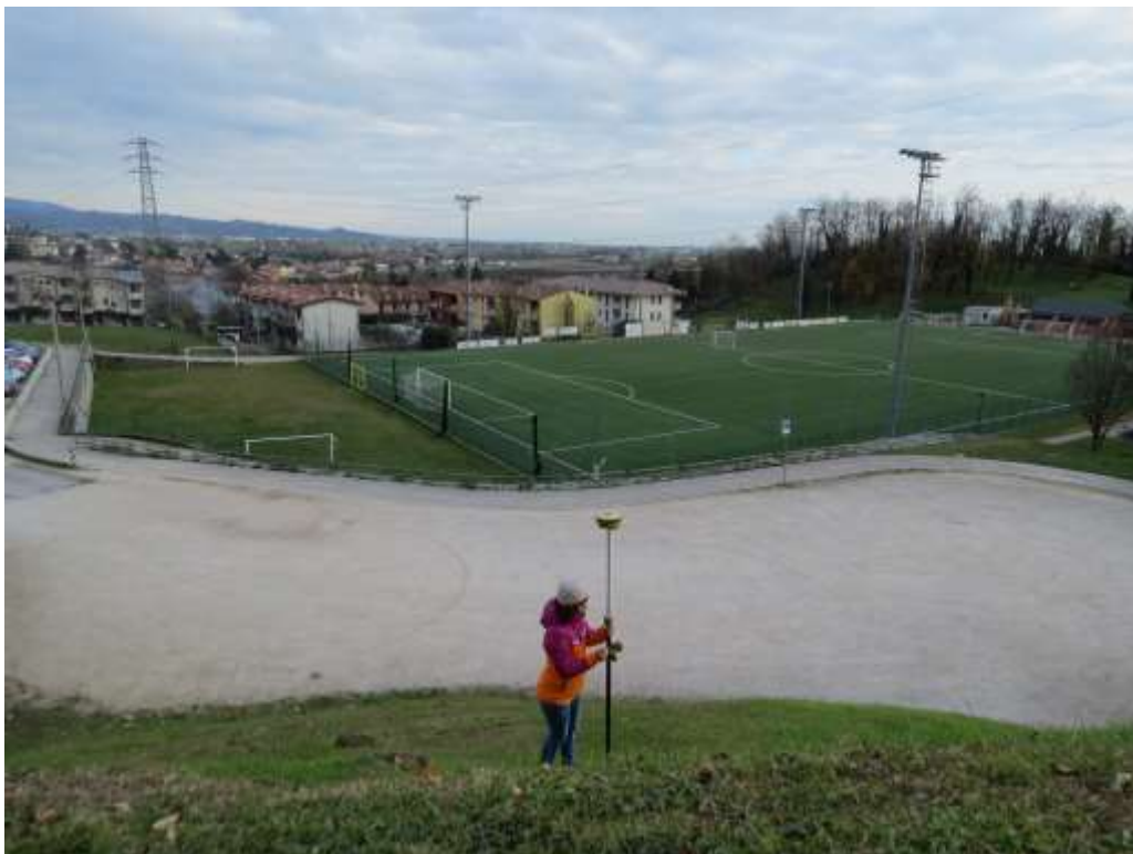
Figura 7.13. Raccolta dei punti GPS (Topcon Hyper V) per progettazione del tubo in uscita dal rain garden sfociante nel versante Sud-Est della Piazza in concomitanza con il parcheggio del campo sportivo.
