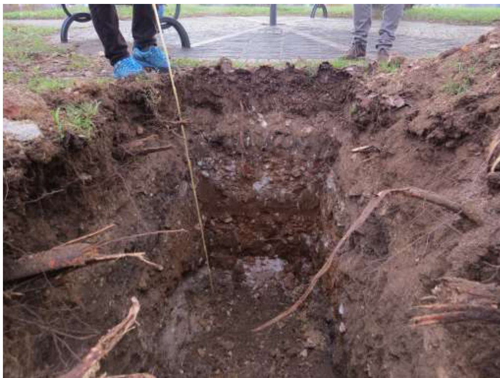
Figura 7.16. Profilo pedologico dello scavo con riferimento metrico. Profondità di scavo 1,5 m.
